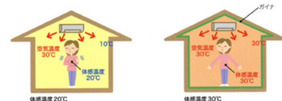
室内空気温度が30℃で、壁・天井の表面温度が10℃である左図の部屋の体感温度は20℃となります $[(30℃ + 10℃) \div 2 = 20℃]$ 。ガイナを施工した右図の部屋は、室内空気温度が同じ30℃でも、壁・天井の表面温度が室内空気温度に順応し、体感温度が30℃となり、その差は10℃も高くなります $[(30℃ + 30℃) \div 2 = 30℃]$ 。
