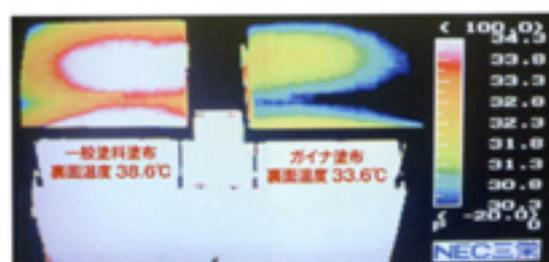
▲ 一般塗料塗布コンクリートの表面温度は、38.6℃、ガイナ塗布コンクリート表面温度は、33.6℃となった。
