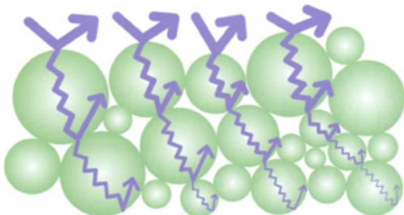
ガイナの塗膜は、硬いセラミックの中に空気を含んだ球体の多層で構成されています。
