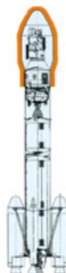
宇宙航空研究開発機構 (JAXA) は、H-II ロケットの開発に際して、打ち上げ時の熱から機体および人工衛星を守るために、ロケットの先端部 (フェアリング) に塗布する断熱技術を開発。
