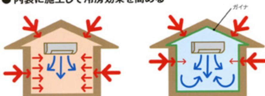
室内空気温度がいくら低くなくても、壁・天井の温度が高ければ、熱は室内へ侵入します。
