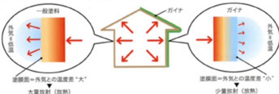
熱は、高いところから低いところへ移動する性質を持っています。ガイナを外装に施工すると、外の空気温度とガイナを塗布した表面温度が適応することによって熱の均衡化が起き、その表面で熱の移動を最小限に抑えます。この働きにより、外部からの冷気の影響を遮り、室内の熱を外へ逃がしにくくします。
