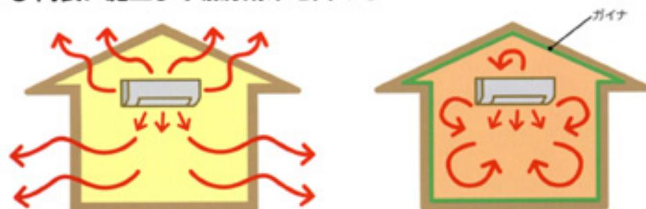
室内空気温度がいくら高くなっても、壁・天井の温度が低ければ、熱は壁・天井から逃げます。ガイナを内装に施工すると、室内空気温度とガイナ表面温度が適応することにより、熱の移動を最小限に抑えます。
