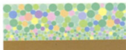
ガイナは、特殊セラミック層で構成されています。この特殊セラミックが、周辺温度に適應する性質があり、その結果、熱の均衡化をもたらし、熱の移動を抑える働きをします。
